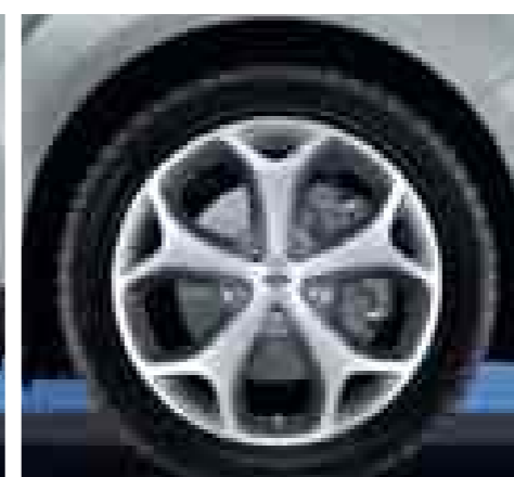
18-дюймові 5-спицеві легкосплавні колісні диски верстатної обробки з Y-подібними спицями (стандарт у Titanium S, опція у Trend і Titanium)
